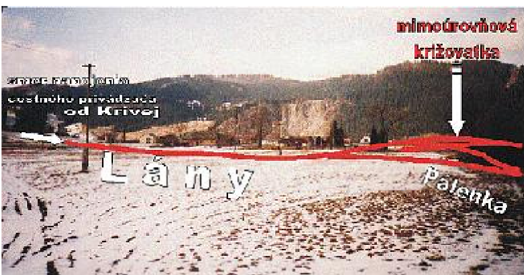
Mimoúrovňová križovatka v lokalite Pálenka zaberie kruhový priestor o polomere takmer 200 metrov a vzdialenosť oblúkov križovatky od rodinného domu č. 54 (Vasek) je desať metrov.
